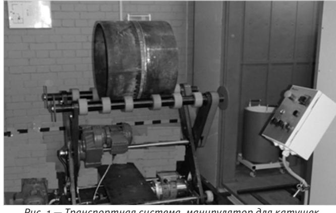
Рис. 1 — Транспортная система, манипулятор для катушек больших диаметров, выносной пульт управления и кабина радиационной защиты комплекса «КАРАТ»
