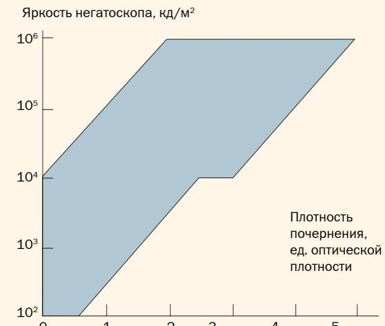
Рис. 1. Требования к яркости негатоскопов в ОСТ 108.004.110-87
